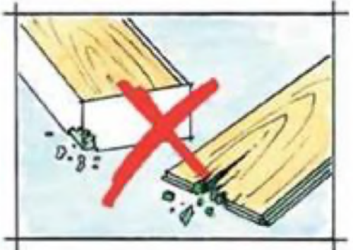
Älä asenna vaurioituneita lankkuja.
