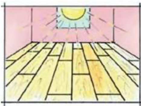
Asenna laudat päävalon suuntaisesti.
