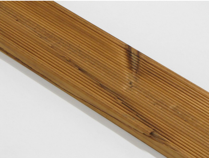
Osittain reunalohjennut kappale on sallittu
